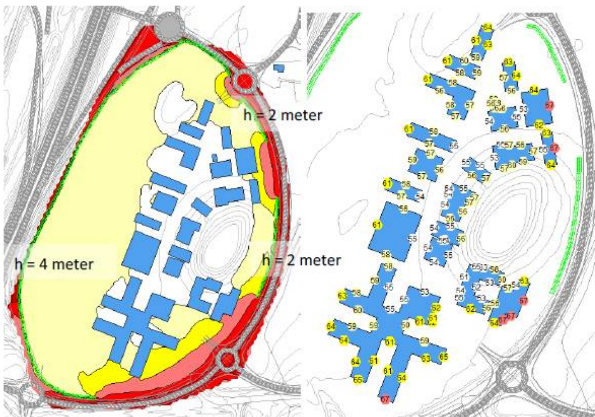
Figur 32: Beregnet støynivå uten støyskjerm i sør i Delområde 1. Støynivå er beregnet i 1,5 m høyde. Figuren til høyre viser fasadenivå i mest støutsatte etasje.
